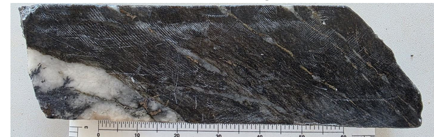
TBS_019, 0.5m @ 47.2 g/t Au, 4.03 % Pb, 1.535 % Zn, 64 g/t Ag 2
